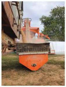
Le chargement gauche / droit est un chargement à 360 degrés Système, qui permet à l'opérateur de vider une remorque, charger la trémie du moulin, traiter le grain et stockeren une seule opération pratique.
