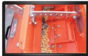
Lorsque vous avez besoin de changer le degré d'aplatissage ou d'éliminer un blocage il suffit simplement d'actionner le manche prévu à cet effet. Cela permet :
